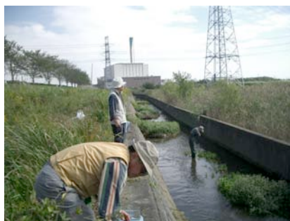
調査箇所③の湧水路での調査状況。公園計画地の裏側の小畔川沿いを流れるコンクリート三面護岸の湧水路。水深 15 cm程度で土砂堆積、外来種のおオカワジシャが繁殖。水の流れ速い。
