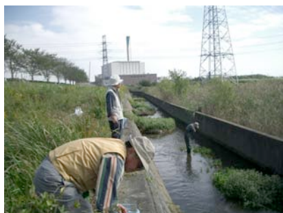
調査箇所③の湧水路での調査状況。公園計画地の裏側の小畔川沿いを流れるコンクリート三面護岸の湧水路。水深 15 cm程度で土砂堆積、外来種のおオカワジシャが繁殖。水の流れ速い。
